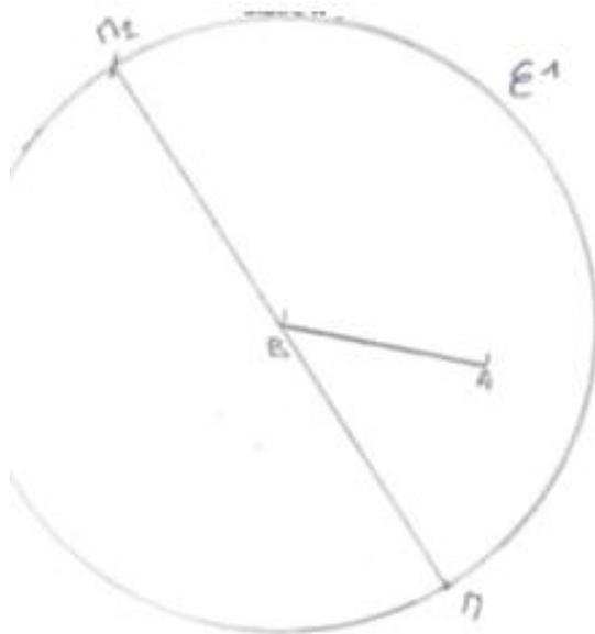
On trace le cercle  $E^1$  de centre  $B$  et de rayon  $[BA]$ . On trace le diamètre  $[M_1M_2]$  et on obtient  $M_2$  un point du cercle  $E^1$ .
