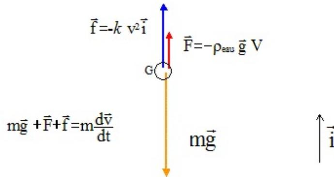
Figure 6: Chute d'une bille dans un fluide
