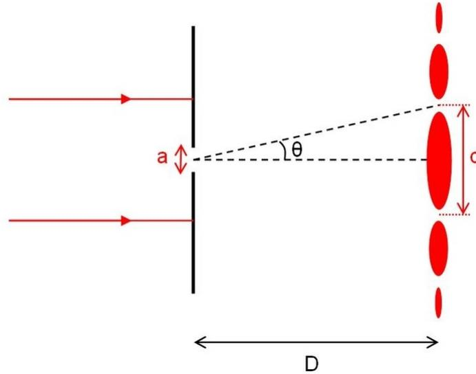
Figure 4: Diffraction par un trou
