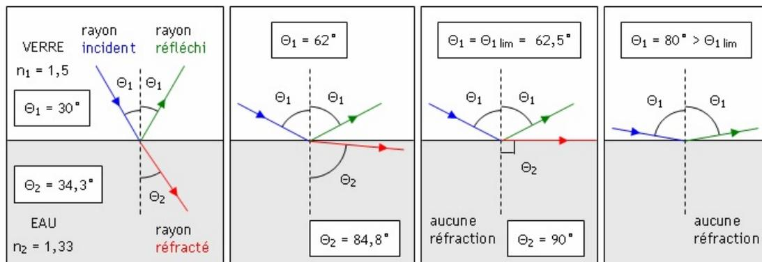
Figure 5: Illustration de la notion d'angle limite
