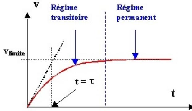
Figure 7: Graphique représentant  $v = f(t)$  lors de la chute d'une bille dans un fluide
